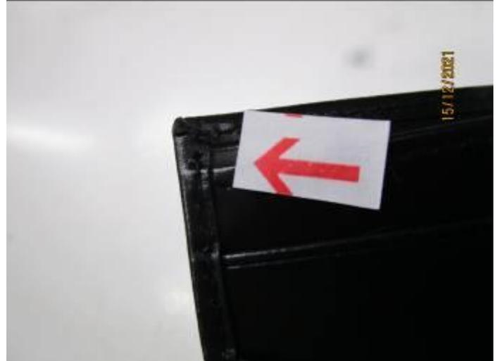
DEFECT 1: IMPROPER EDGE FINISHING
