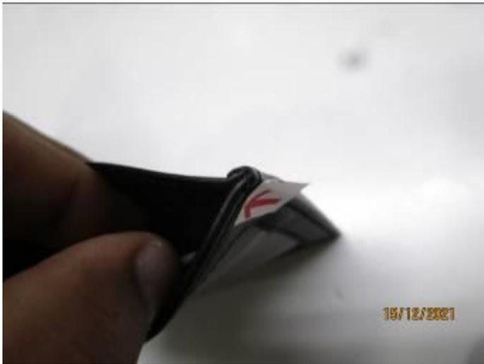
DEFECT 5: INSECURE EDGE JOINT
