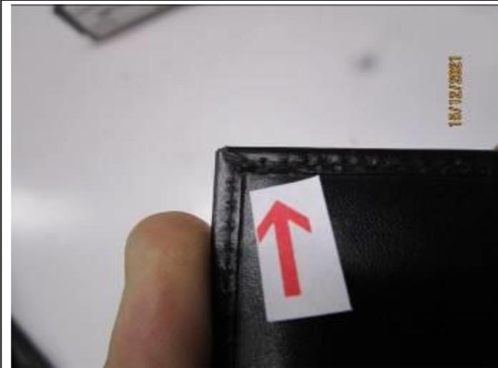
DEFECT 1. IMPROPER FINISHING OF SIDE
