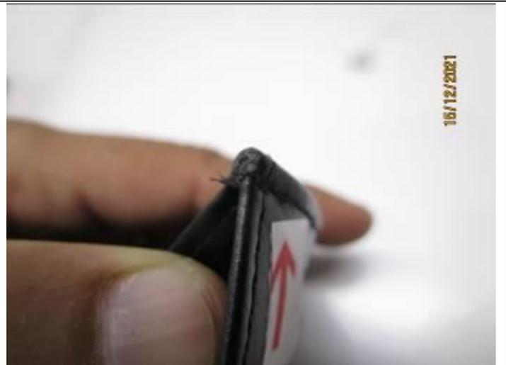
DEFECT 4: INSECURE EDGE JOINT
